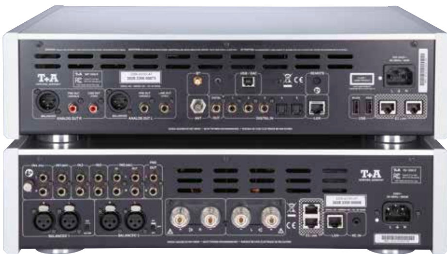
▲ Die prallen Anschlussfelder der beiden „Es“: Die Balanced Ins des Verstärkers (unten) lassen sich über Taster deaktivieren oder ersetzen je einen der unsymmetrischen Anschlüsse.
