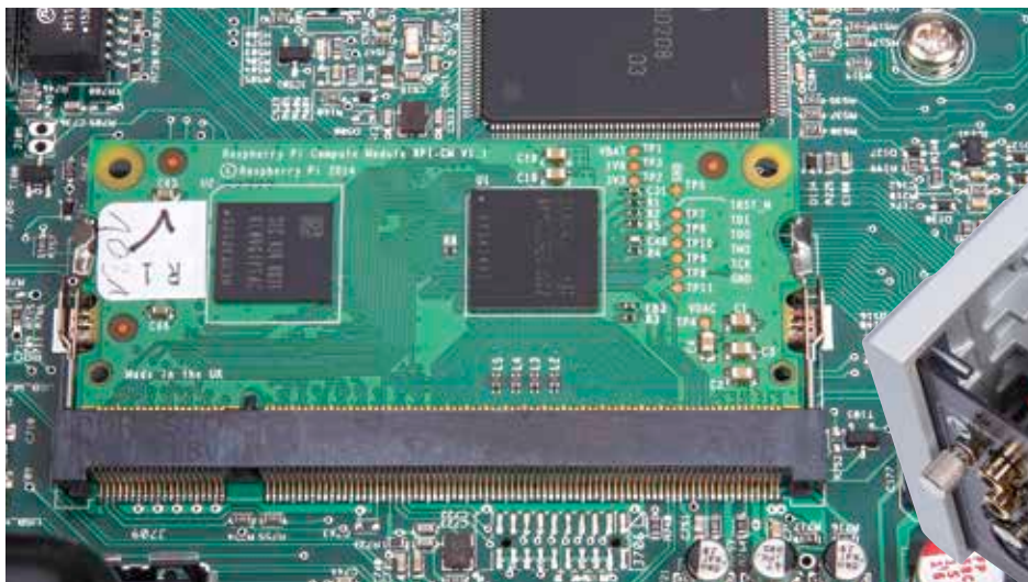
▲ Der neue Computer-Kern, der sämtliche Medienspieler-Aspekte des MP 1000 E abhandelt, ist auf einer austauschbaren Platine untergebracht.
