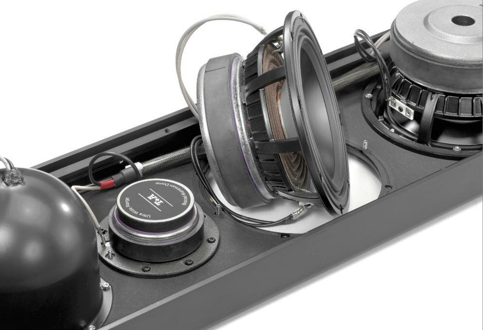
Hier sieht man die hauseigenen Chassis aus der Nähe. Der Hochtöner spielt geschützt vor Reflexionen in seiner eigenen „Behausung“. Die Tieftöner zeichnen sich unter anderem durch eine Doppelsicke, sehr starke Ferrit-Magnete, Schwingspulen aus kupferkaschiertem Aluminiumdraht auf Kaptonträgern und einen steifen, resonanzarmen Korb aus
