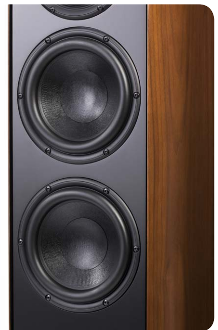
Die üppig dimensionierten Tieftöner haben besonders steife Membrane und strahlen rückwärtig in den Transmissionline-Kanal ab
