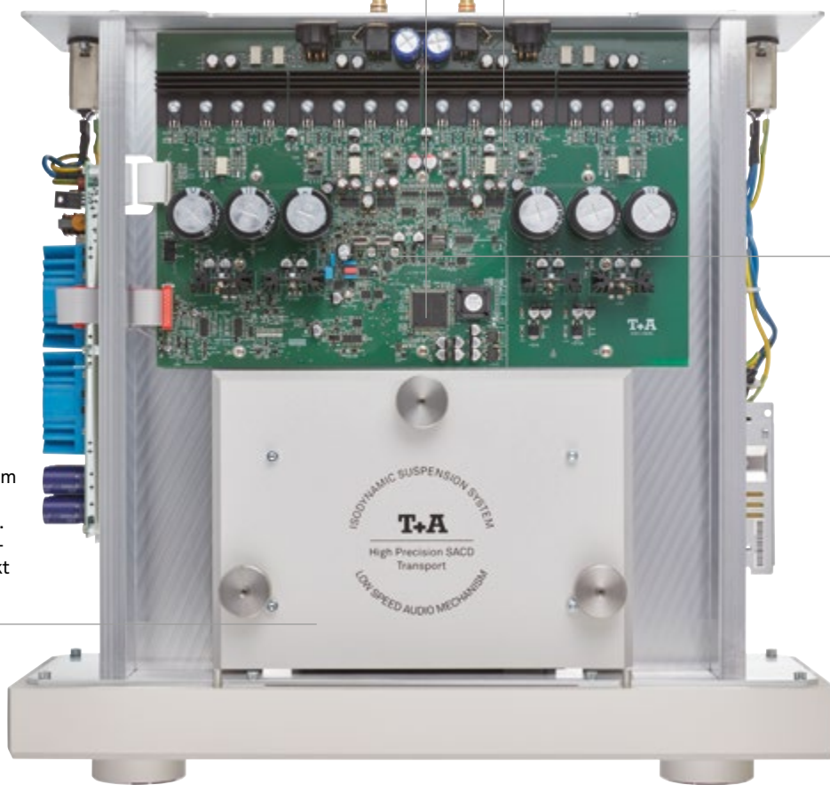
Innenansicht des oberen Gehäuse-Compartments MP 3100 HV
