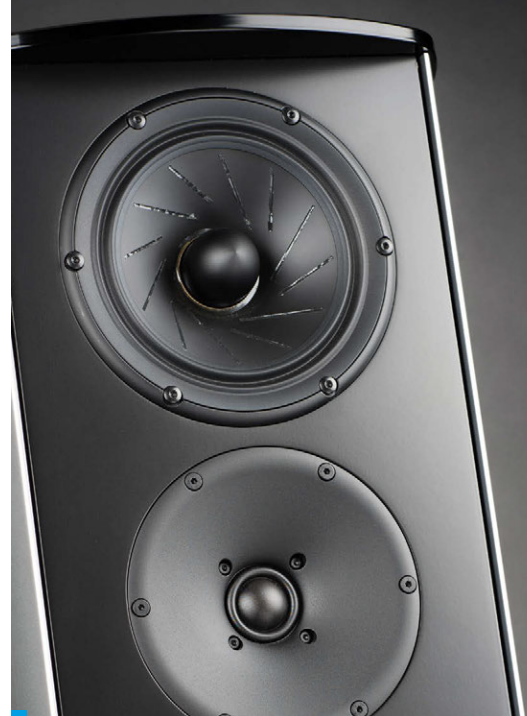
Turbinkowe nacięcia membrany średniotonowej zwiększają jej odporność na rezonanse mechaniczne. Falowód tekstylnego tweetera modyfikuje jego dyspersję, redukując tzw. lobing.
